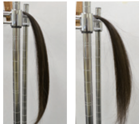
コンディショナー処理後の毛束 (左: 添加剤無し・右: プラスサイズ L-450配合)
