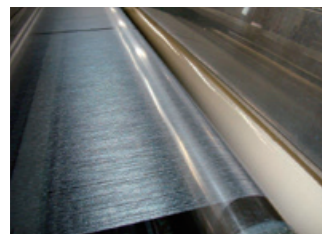
ノリ付け工程 糸にノリ剤を含浸加工する。
