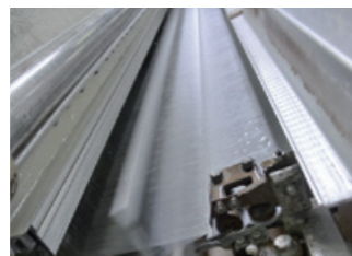
製織工程 (ウォータージェットルーム) ノリ付け糸を製織する。糸から織物へ。
